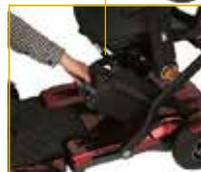
Batería de litio extraíble (14,5 Ah) para facilitar su carga.
