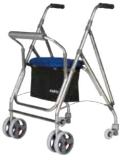
Fabricado en aluminio. Empuñaduras de goma y regulables en altura. Dobles ruedas delanteras giratorias. Ruedas trasera con frenos por presión. Respaldo acolchado. Plegable. Cesta porta-objetos de tela.
